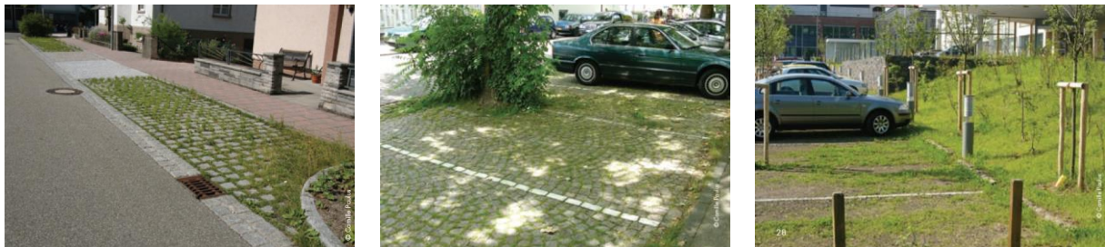
Figure 23 : exemples d’aménagement de parking écologique
